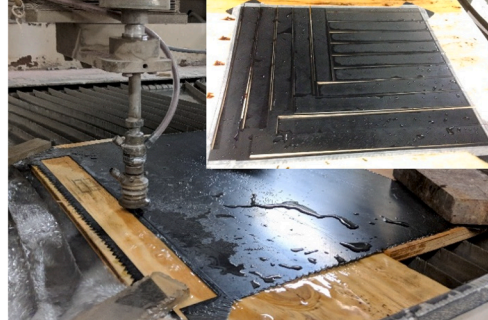
(d) Water Jet Cutting Apparatus
